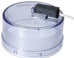
I tentativi di frode dei dispositivi lancia impulsi consistono nell'utilizzo di magneti esterni che, avvicinati ai dispositivi stessi, alterano il corretto funzionamento del contatto elettrico. B METERS, su richiesta, fornisce dispositivi lancia impulsi dotati di un ulteriore contatto REED che, all'approssimarsi di una forza magnetica esterna, genera un segnale di allarme.
